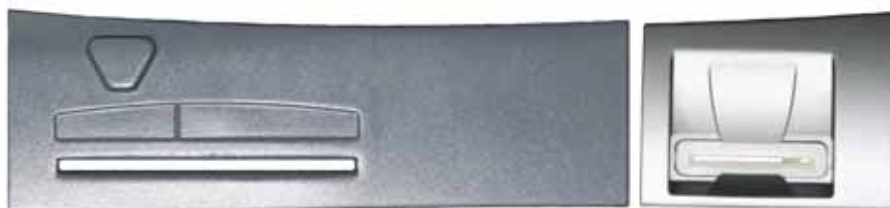
Ил. 1. Общий вид фальшивой накладной панели и картридера
