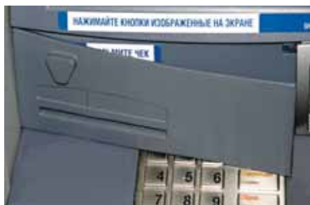
Ил. 4. Способ установки фальшивой накладной панели
