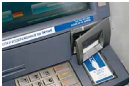
Ил. 5. Способ установки фальшивого картридера
